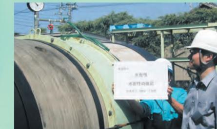
スナップロック工法MLの外水圧試験
