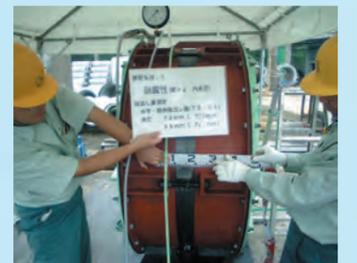
鋼製分割型内水圧水密試験装置
