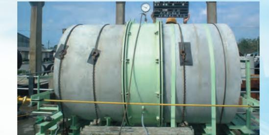
外水圧水密試験装置の全景(呼び径 1350)
