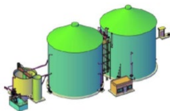
メタン発酵槽
