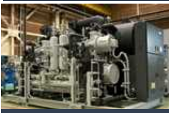
高効率冷凍機 (前川製作所)
