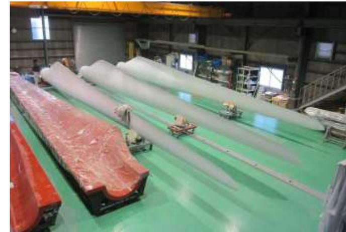
風車ナセル組立・ブレード製作
