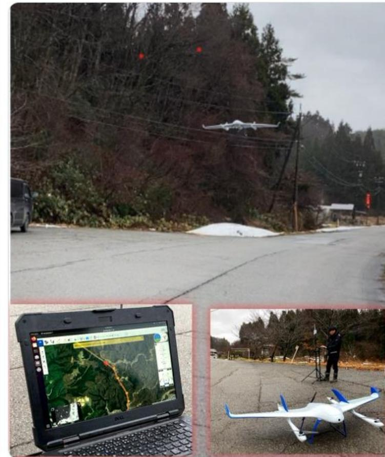
小型ドローンを何回も飛ばすよりも、VTOLであれば一気に素早く正確に測定できる、国道・県道・市道・農道もまとめて一気に撮れる
