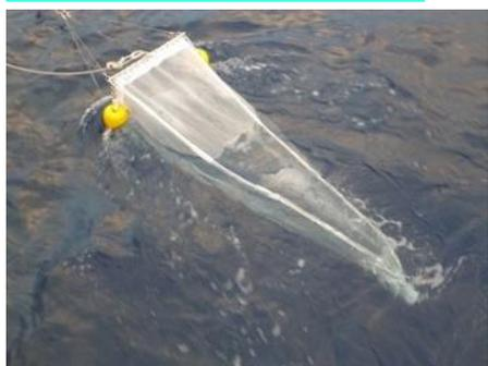
ニューストーンネットによる漂流マイクロプラスチックの採取
