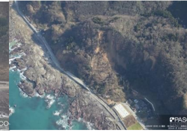
珠洲市 馬繰町付近 崩壊土砂が道路・人家周辺に堆積
