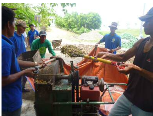
破碎機による生ごみの破碎状況
