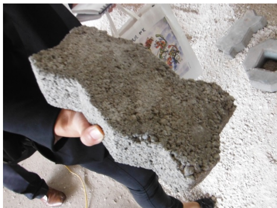
写真 添付①-49. リサイクル品を使用したブロック
