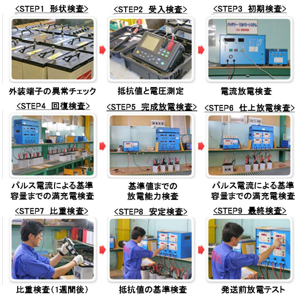
図 2-3 再生段階の詳細フロー
