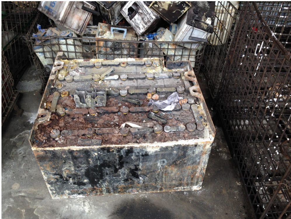
図 3-12 フォークリフトから発生した廃鉛バッテリー
