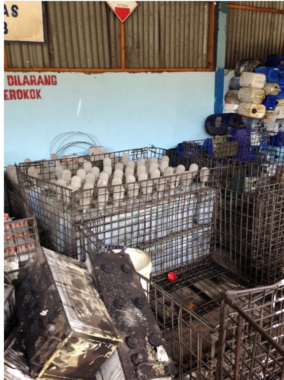
図 3-11 ラックで管理された廃鉛バッテリー②
