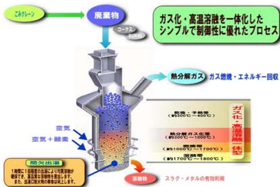
図 2-1 シャフト炉式ガス化溶融炉
