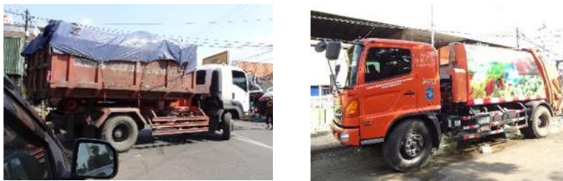
図 3-2 スラバヤ市で稼働しているごみ収集運搬車 （左：アームロール車 右：コンパクター車）
