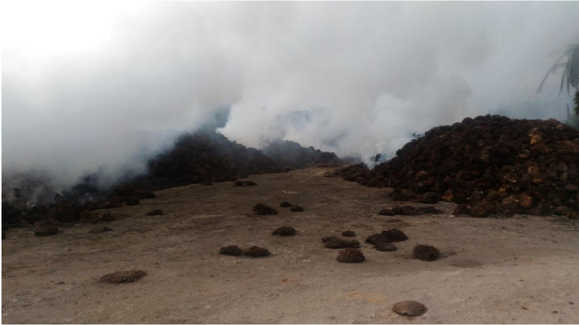
図 3-20 EFB 焼却灰製造処理（油やし農園、工場敷地内）
