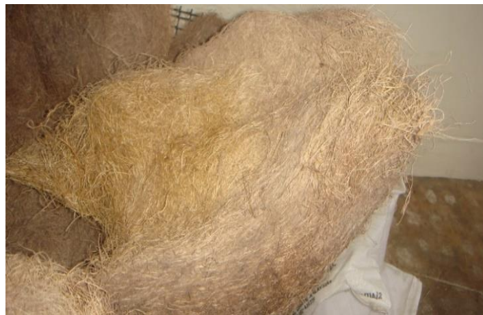
図 3-23 ロングファイバー（車のシートなどに使用されている）
