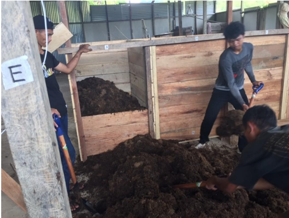
図 6-12 軽量コンクリート製品端材を用いた EFB の堆肥化試験
