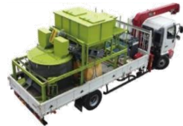
図 2-3 車載式小型生コンプラント「モバコン」
