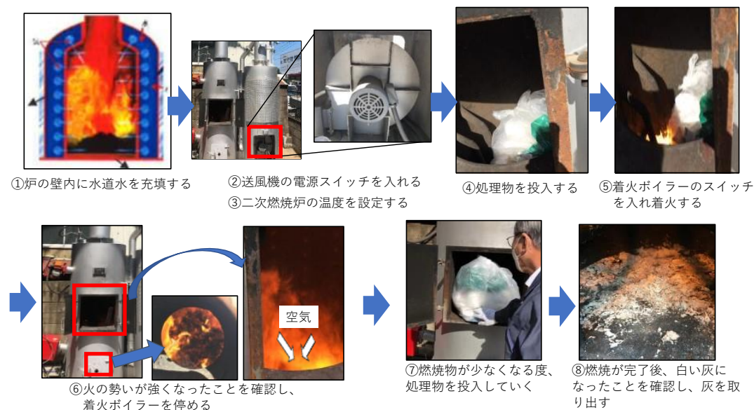
図 2-6-4-1.小型無煙焼却炉の操作手順
