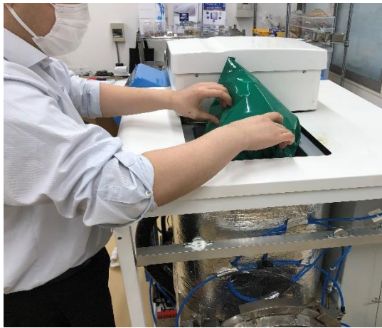
B 社：破砕機付き高圧蒸気滅菌器 2月18日に訪問。
