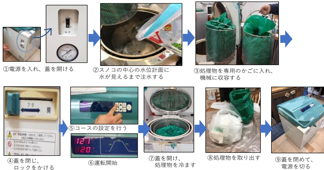
図 2-6-2-1.高圧蒸気滅菌器の操作手順
