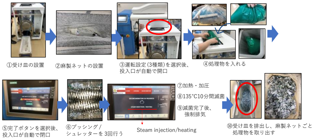
図 2-6-3-1. 破碎機付き高圧蒸気滅菌器の操作手順
