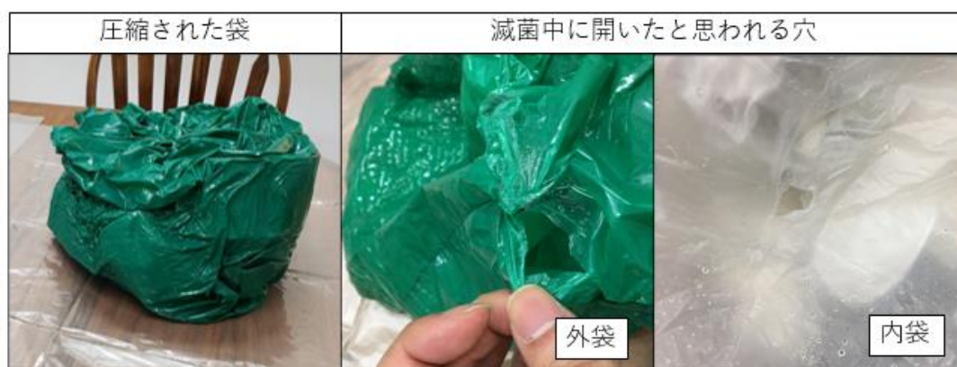
図 2-6-2-2.滅菌により圧縮された袋と穴の開いた袋
