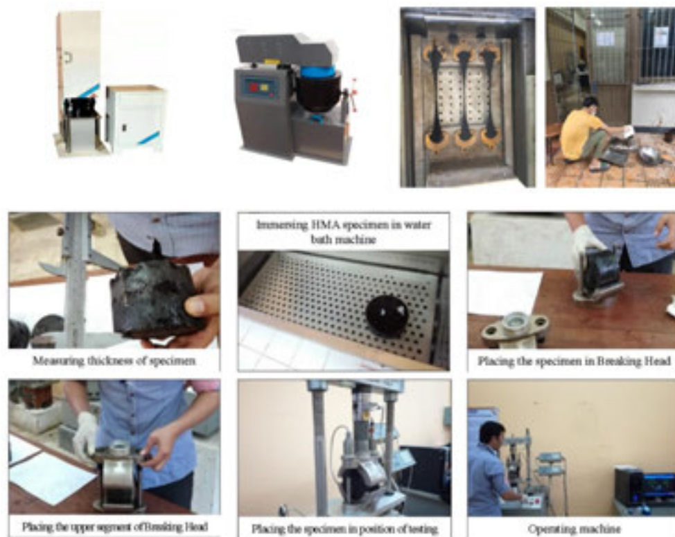
図 4-2-1 ICT による廃プラ利用による改質アスファルト研究状況
