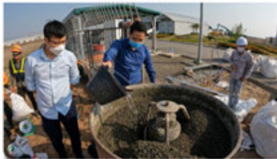
レンガ舗装材製造状況
