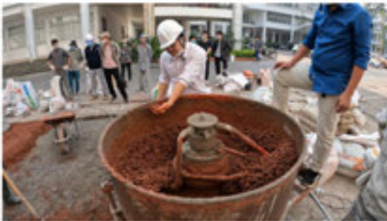
レンガ舗装材製造状況
