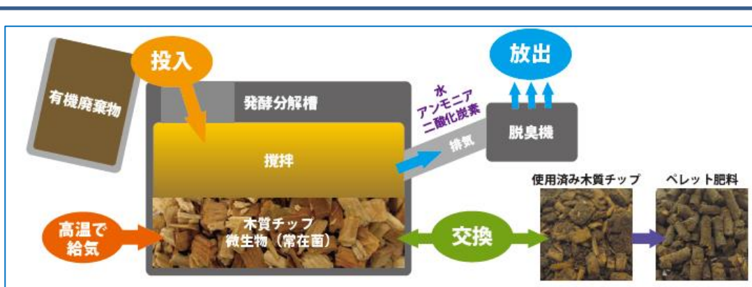
図3 木質チップにおける発酵と分解
