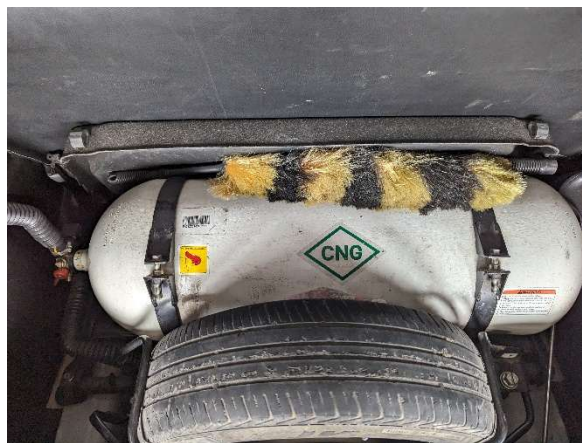
タクシーのトランクを開けると CNG ガスタンクがあることがインドでは珍しくない。
