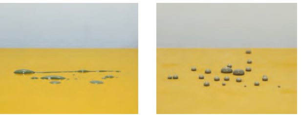
従来型枠：コンクリートのセメント分が型枠表面に付着する アート型枠：コンクリートのセメント分は型枠表面に付着しない
