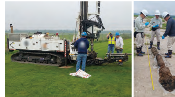
試験用土壌サンプリング作業(米国内)
