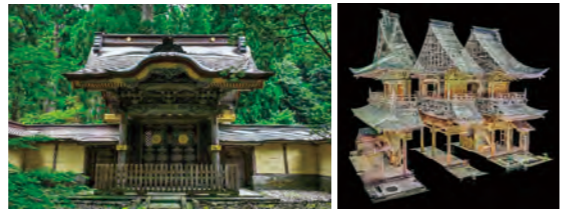
山門の点群データ(外観と内部を同時に表示) 永平寺・清水建設共同調査 測量協力T&I 3D
