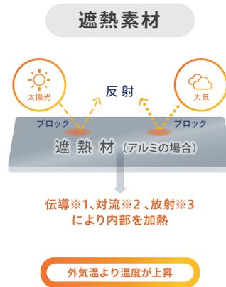
太陽光等を素材の表面から室内への入熱を小さくした素材。太陽光等が当たると外気より温度が上昇。
