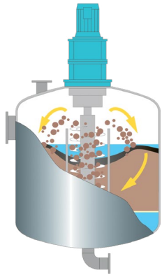
سيفون لغسل الرمال المخصصة لتصفية المياه
