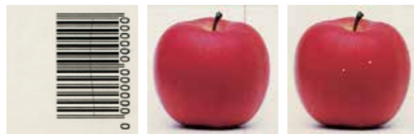
検出欠点例(髪の毛) 検出欠点例(スジ) 検出欠点例(ピンホール)
