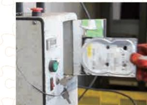
HDD破壊装置
