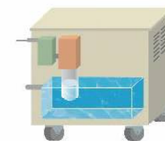
チラータンク
