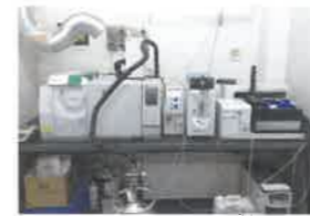
パージアンドトラップガスクロマトグラフ 質量分析計 (水道水中の有害物質分析)
