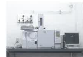
ガスクロマトグラフ質量分析計 (農薬の分析)
