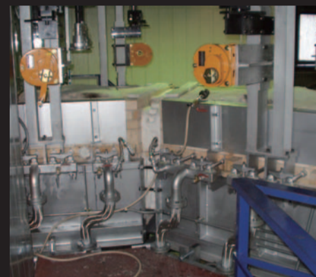
フォアハース燃焼器 Burner of Forehearth
