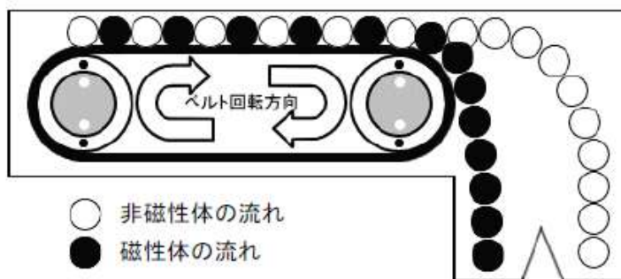
◇ マグネットセパレーター原理図 ◇
