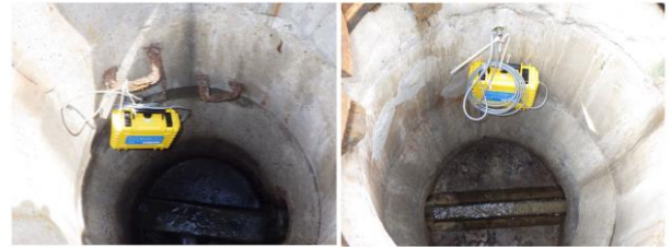
左：足掛け金物に設置した事例 右上：アンカーを打ち込んで設置した事例 左下：転落防止はしごに設置した事例
