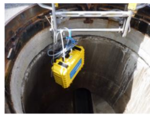
左：足掛け金物に設置した事例 右上：アンカーを打ち込んで設置した事例 左下：転落防止はしごに設置した事例
