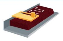
L-12型 式 醗酵堆積幅 11m 堆 積 高 1.8m 長 50m 1日処理量 約33m<sup>3</sup>
