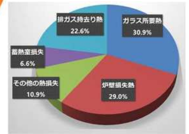
ガラス溶解炉（溶解室）におけるエネルギー消費割合の一例
