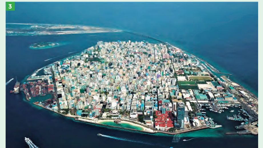
1 護岸機能も備えたマレ島東海岸の人工ビーチ。住民の憩いの場となっている。2 ミードウ島における海岸浸食の実態調査の様子。3 マレ島の住宅地拡大に伴うラグーンの埋め立てが、高潮のリスクを増大させる一因となった。
