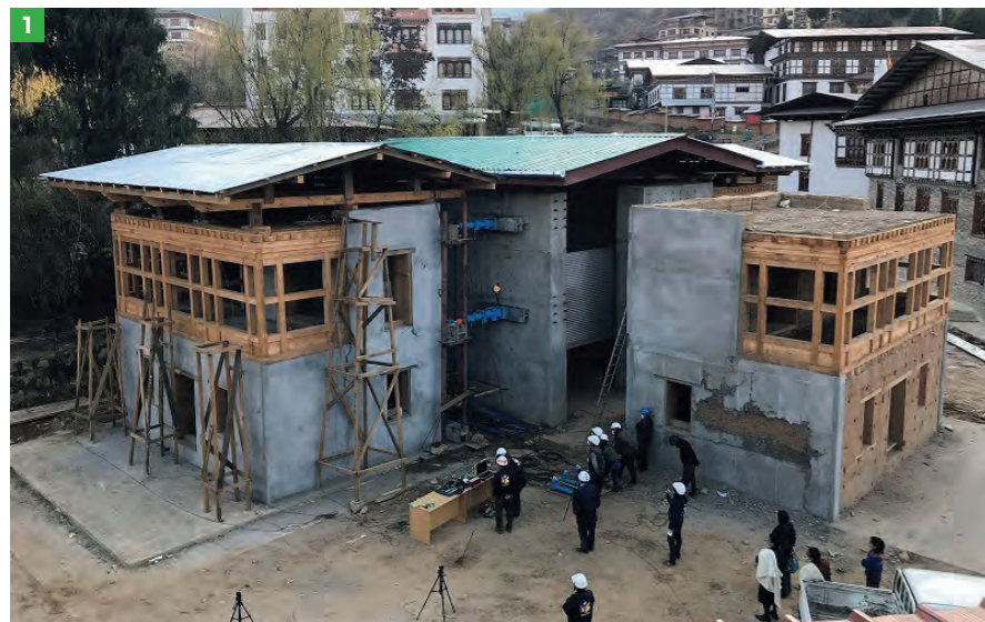
1 2019年、ブータンの内務文化省文化局の敷地内にて、耐震性を向上した実物大の版築造の建物を使った実験を実施。 2 22年に行われた、実物大の石積造の建物を使った実験の様子。3 ドローンを使い詳細な地形調査を行った。
