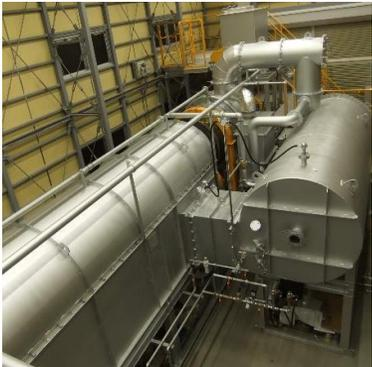
アルミに付着したプラスチックを熱によって除去。
